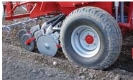
Roue large pour un entrainement de la distribution fiable.
