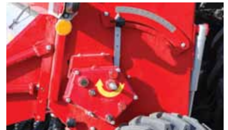
Variateur VARIO-K, réglage de la densité précis et simple.
