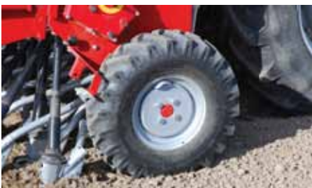
Pneu à profile agraire équipé de décroctoïr.
