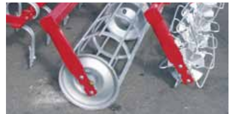
Les rouleaux contrôlent la profondeur de travail.
