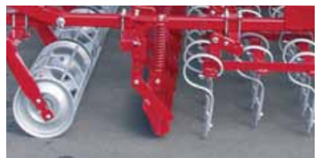
Planche niveleuse réglable montée sur ressort.
