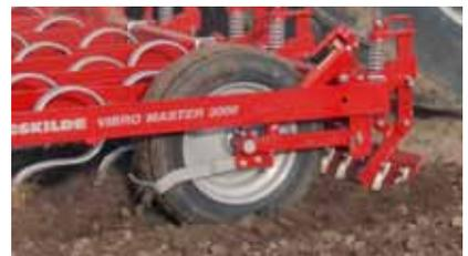
Les 4 roues pneumatiques sont disposés à l'avant des dents et ainsi évolue sur un sol ferme.
