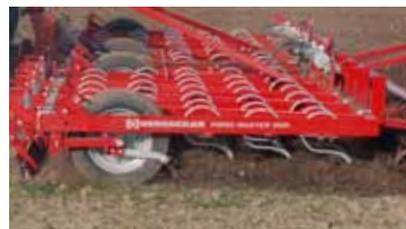
Les 5 rangées de dents permettent, grâce à une implantation symétrique de dents, un flux de terre et de végétaux régulier.
