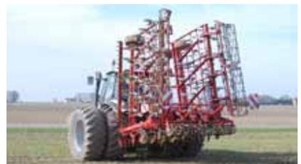
Repliage vertical au transport à 3m de large.
