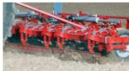
La planche de nivellement décroûte et nivèle le sol pour un travail optimal des dents vibrantes. Deux positions sont possibles.
