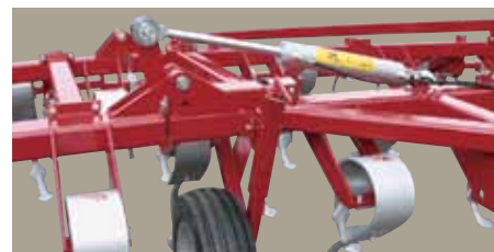
Repliage et dépliage des extensions à l'aide de deux vérins double effet.
