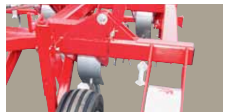
Réglage par manivelle des roues 600 x 12.
