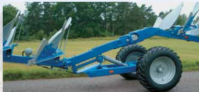
La conception de l'interface entre l'essieu et la charrue est simple. Une suspension sur le vérin de levage procure de la souplesse au transport.
