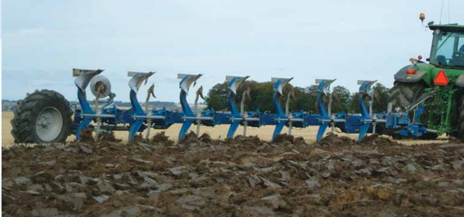
Vari Flex EVL 7180H muni d'un vérin de déport hydraulique.
