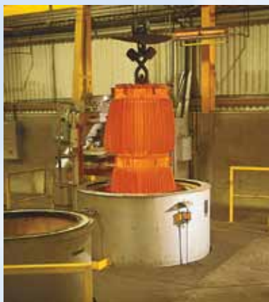
Cémentation des matrices de versoirs.
