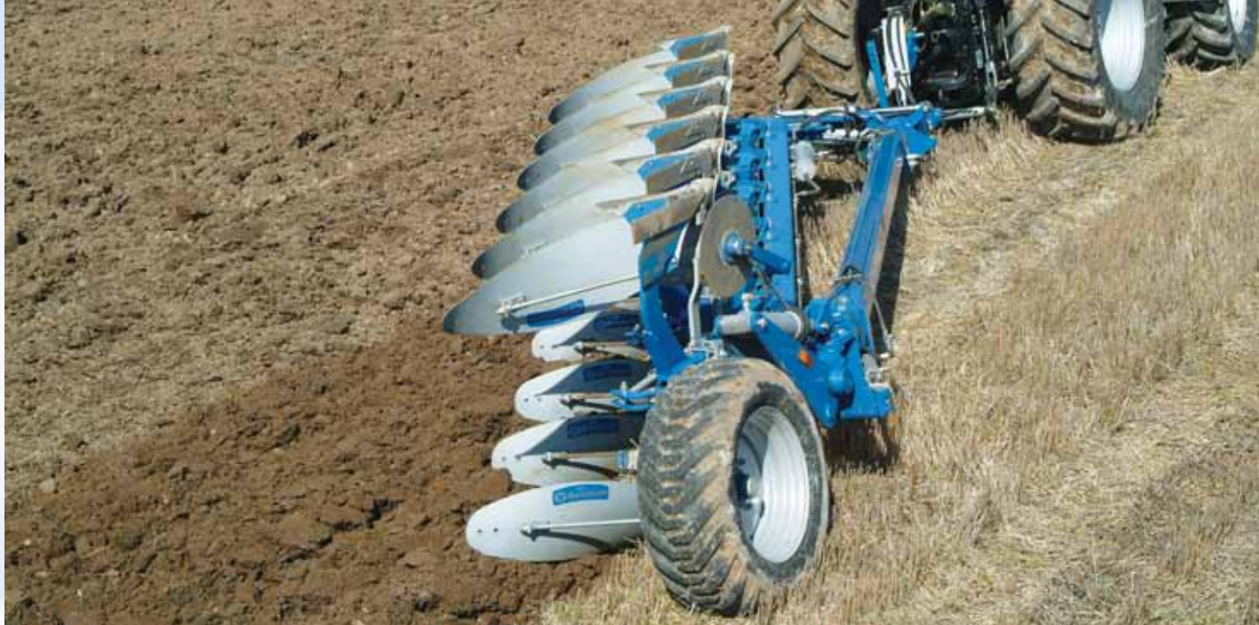
CVL 6975H. La poutre latérale est placée de manière à améliorer le dégagement.
