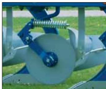
Coudre circulaire lisse avec ressort de sécurité.
