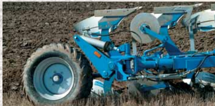
La roue large procure peu de résistance, ici avec sont vérins.
