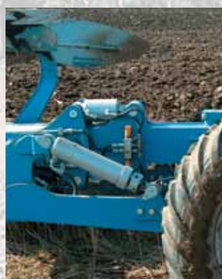
La poutre arrière possède une suspension hydraulique surdimensionnée afin de travail indépendamment de l'avant.
