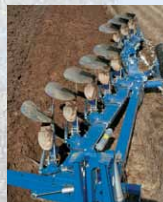
Överum DXL 81075H, le déport hydraulique est standard. Le réglage de la largeur de travail reste aisé.
