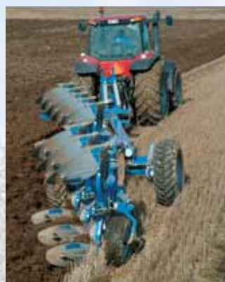
Överum DXL 81075H, le déport hydraulique est standard. Le réglage de la largeur de travail reste aisé.
