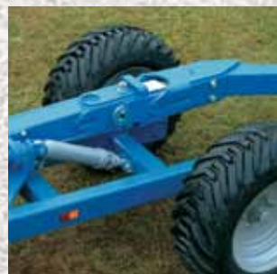
La poutre arrière possède une suspension ressort surdimensionné afin de travail indépendamment de l'avant.
