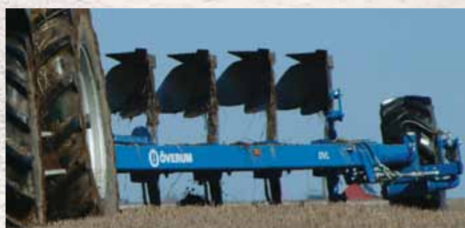
Roue arrière large pour une meilleure répartition du poids en conditions difficiles.
