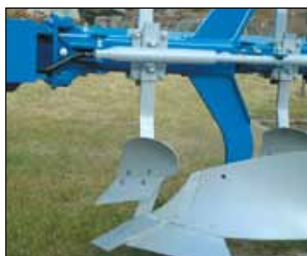
Rasettes EG pour une découpe large et peu profonde. Très bon travail en combinaison avec coudre circulaire et incorporé.
