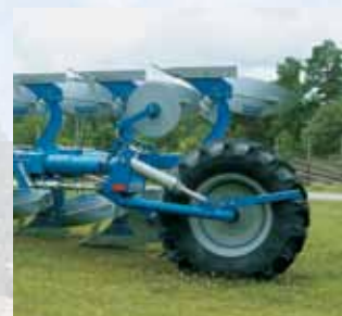
La roue large procure peu de résistance, avec sont vérins.
