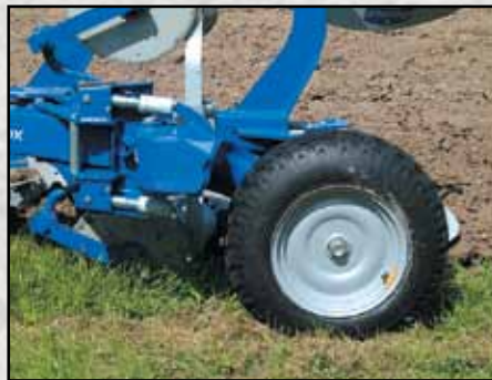
Roue combinée pour Xcelsior 10.50x16. Diam. 755mm, largeur 275mm.
