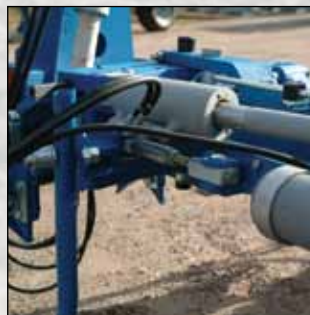
La biellette de réaligement permet un réglage précis pour réduire la puissance de traction nécessaire.
