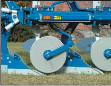
Coutre circulaire fixe. Diamètre 18 et 20 pouces lisse ou 20 gaufré
