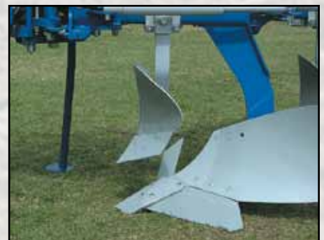
Rasettes EM, Pour labour en présence d'importante quantité de résidus. Excellent travail en combinaison avec coudre incorporé.
