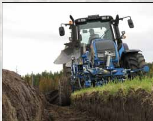
La roue avant contrôle la profondeur de travail et la direction.
