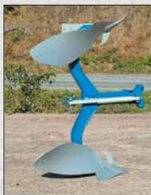
Grace à un grand dégagement et un âge profilé, les résidus ne reste pas bloqués.
