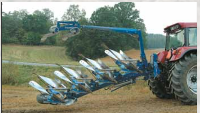
Le mode de retournement "versoires par le haut" est requis avec une herse déportée. Dans cette configuration la hauteur de levage demandé est moins importante.
