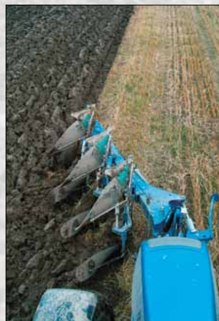
Au travail, la charrue FX laboure l'extérieur du travail et ainsi fait le sillon pour les roués du tracteur.
