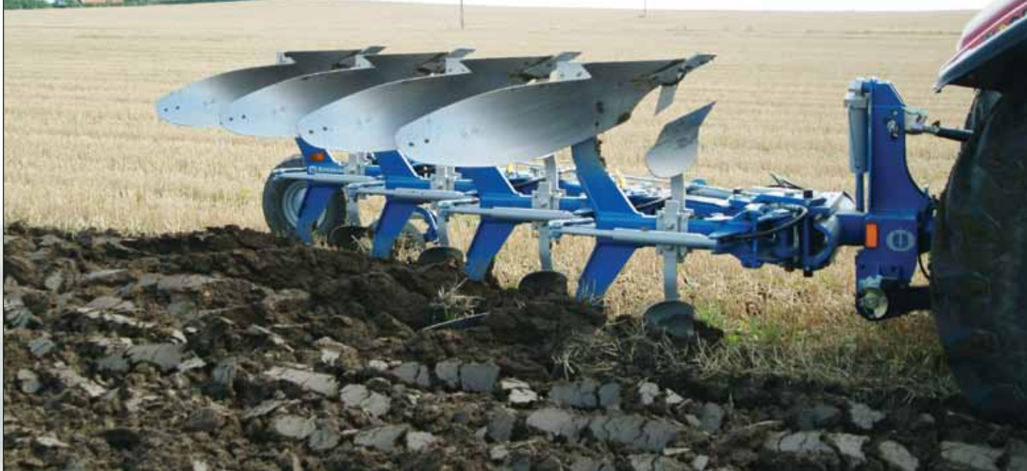
Vari Flex CX 4975 H à largeur variable de 1.2 à 2m de travail.
