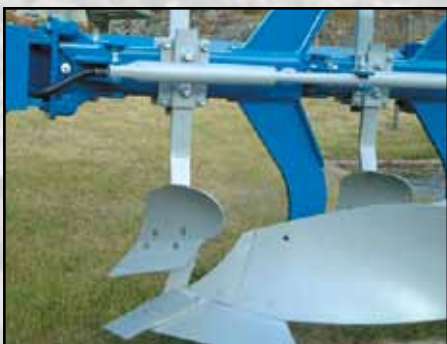
Rasettes EG pour une découpe large et peu profonde. Très bon travail en combinaison avec coudre circulaire et incorporé.
