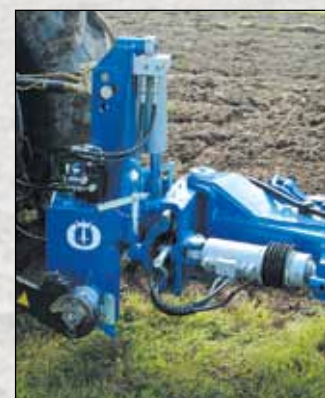
Tête d'attelage avec attelage rapide et vérin d'alignement hydraulique dessiné pour les tracteurs de fortes puissances.
