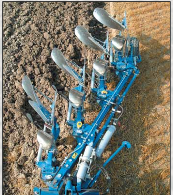
La fabrication d'une poutre percée avec précision a permis l'utilisation d'acier traité thermiquement pour une plus grande solidité.
