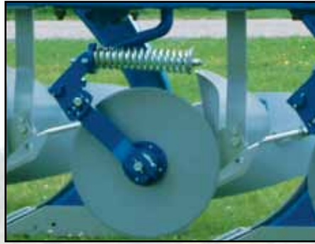
Coutre circulaire à sécurité ressorts. Diamètre 18 et 20 pouces lisse ou 20 gaufré
