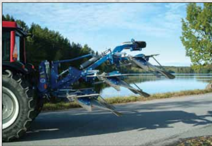
Du fait que la charrue se retourne versoirs en dessous, le centre de gravité de la charrue est très proche du tracteur et donc plus facile à lever.
