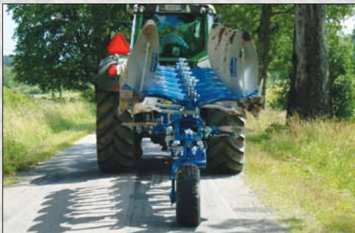
La mise en position transport se fait corps vers le haut, ceci permet de soulager l'arrière des tracteurs pour plus de sécurité.
