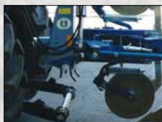
Barre d'attelage rapide pour un attelage rapide en sécurité.
