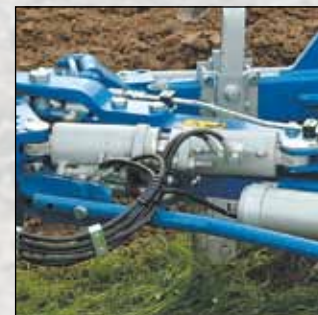
Le double vérin mémorise la largeur de travail pendant le cycle d'alignement et de retournement.
