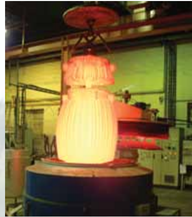
Cémentation des matrices de versoirs.
