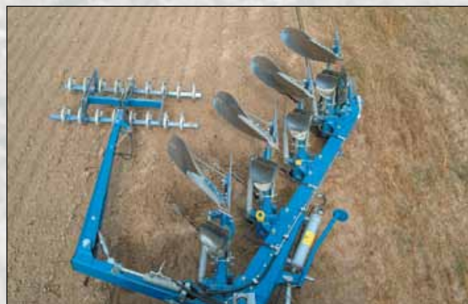
Le profile de la poutre principale est plus large à l'avant de la charrue afin de mieux répartir les forces.
