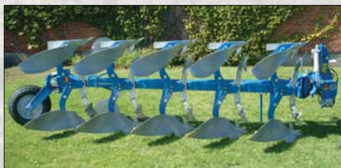
Xcelcior DX 5975 F équipée d'une roue combinée et de rasettes EG.
