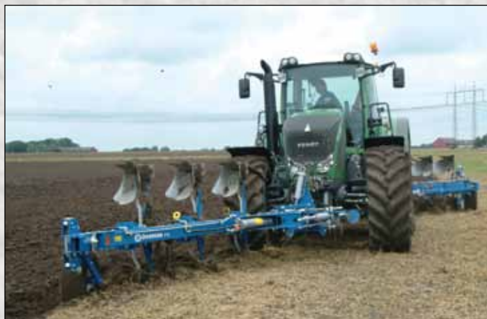
En associant une Vari Flex EX 6975H et une charrue poussée FX 31075H le débit de chantier en est que plus important avec une largeur de travail pouvant aller jusqu'à 4.5m.
