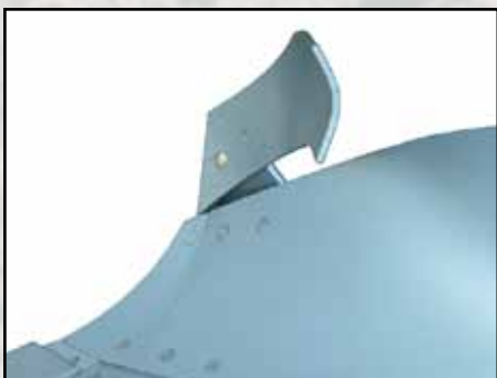
Déflecteur permettent un plus grand dégagement des pailles, Déconseillé en terre collante.
