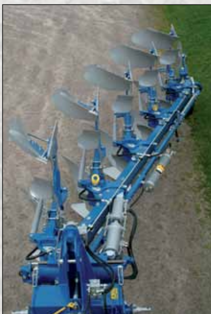
La cinématique de réglage de la largeur de travail permet de travailler à de faible pression.
