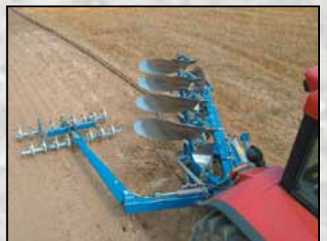
Système Nivellement pour le nivellement avec charrue de 3 à 5 corps Xcelsior.
