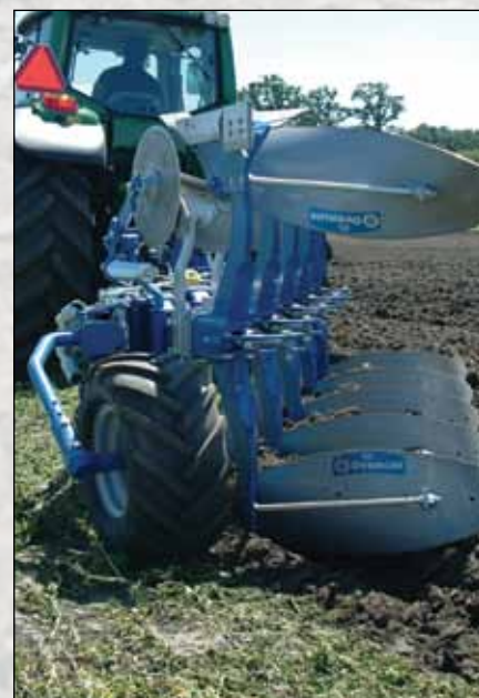
Une nouvelle roue de contrôle de profondeur offre plus de portance grâce un pneumatique plus large et plus de réglage. Lors des opérations de retournement, la roue est amortie par un système de frein à friction.
