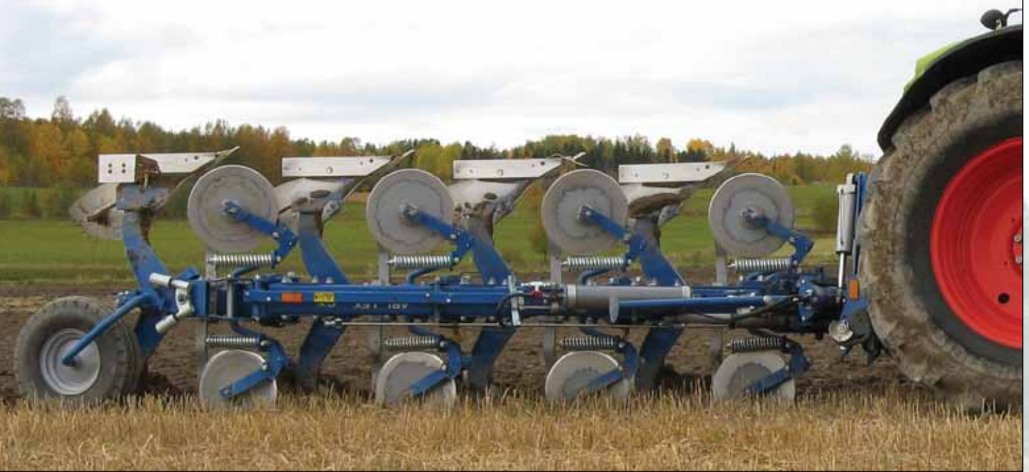
Vari Flex CX 4975 H avec réglage hydraulique de la largeur de 12 à 20 pouces.
