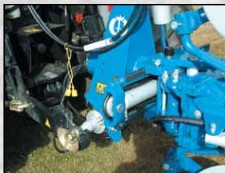
Vérin de réglage de déport hydraulique pour CX et DX.
