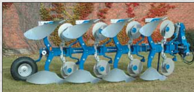
Vari Flex CX 4975 F équipé de coutres circulaires fixes et de rasette EG. Les rasettes et les corps sont équipés individuellement de boulon de sécurité.
