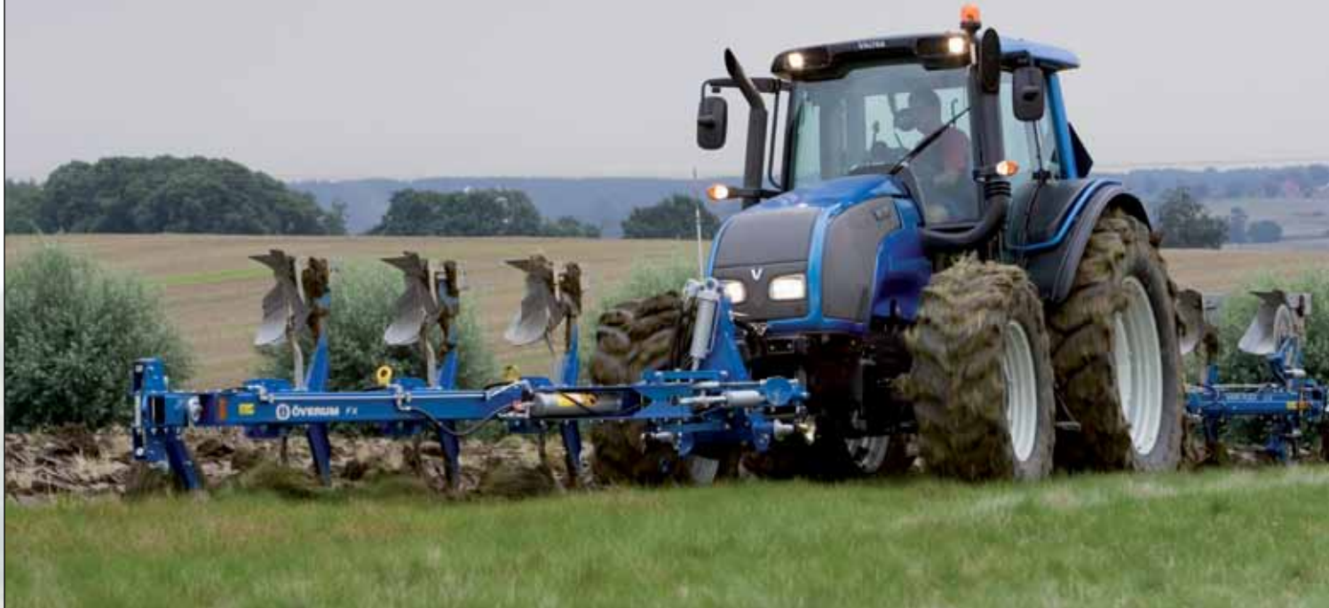
Överum Xcelcior FX 31075 H avec sécurité hydraulique et largeur de travail réglable de 16 à 18 pouces.
