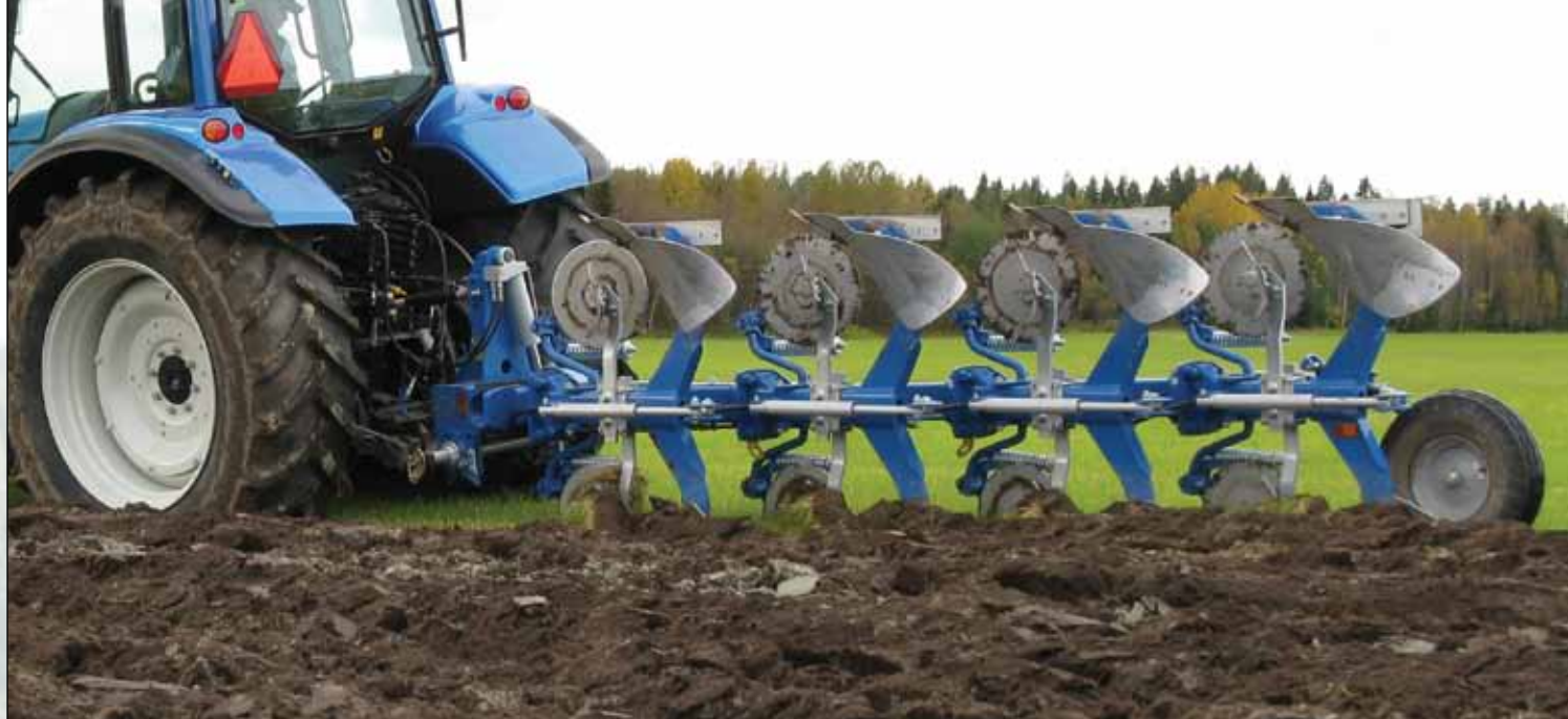
Xcelsior CX 4975 H équipé de coutres circulaires et de rasettes EG. Largeur de travail réglable de 14 à 18 pouces.
