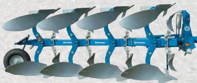
BX 4975 F avec rasettes EM. Chaque corps et âges sont protégés par des boulons de sécurité.
