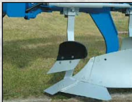
Rasettes EP, versoirs en plastique pour les terres collantes
