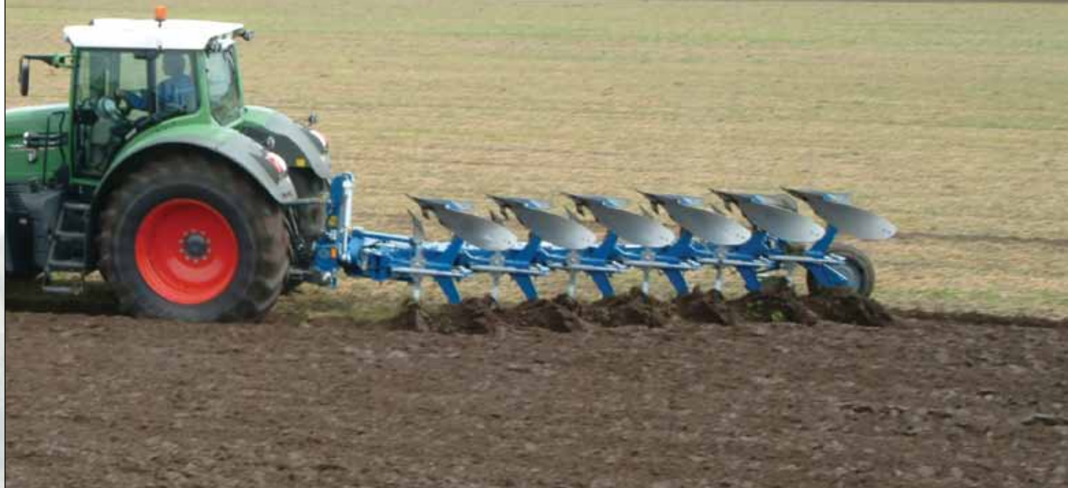
Vari Flex EX 6975 H avec réglage hydraulique de la largeur de travail jusqu'à 3.3m
