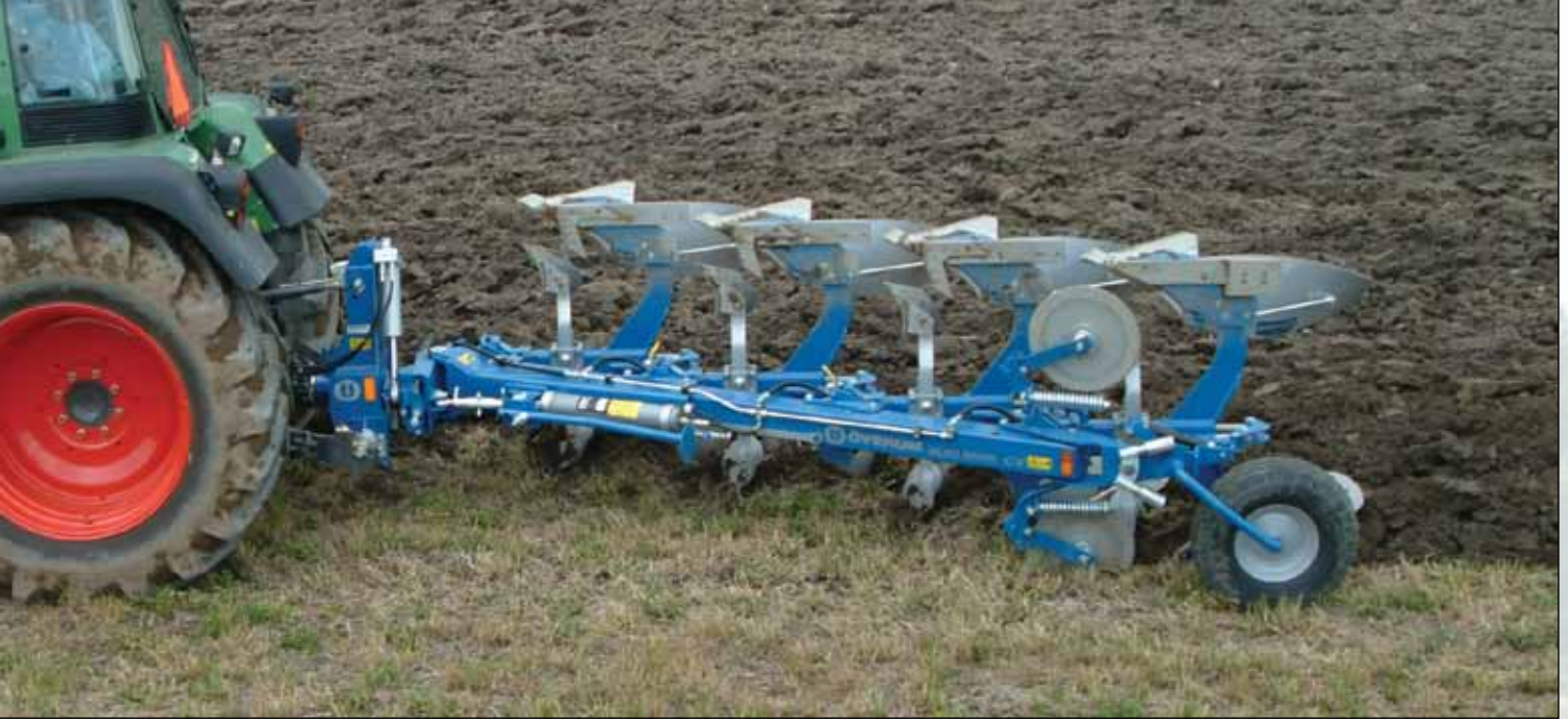
CX 4975 H avec rasettes EG. Le dégagement entre pointes de 90cm permet aux rasettes de travailler efficacement
