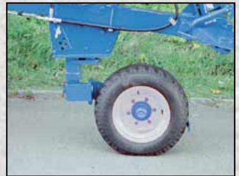
Roue combinée latérale Xcelsior DX, Diam. 755mm, largeur 275mm.
