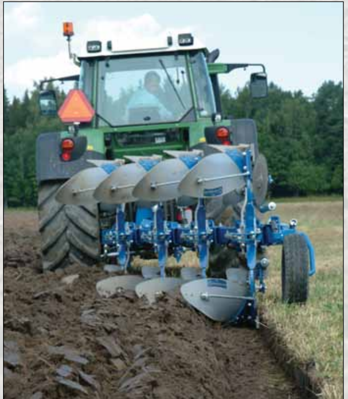
CX 4975 H équipé de corps XL et d'un coultre circulaire pour un bon dégagement de la raie de labour.
