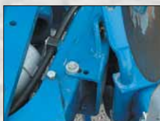
La largeur de travail peut être ajustée en 3 positions.
