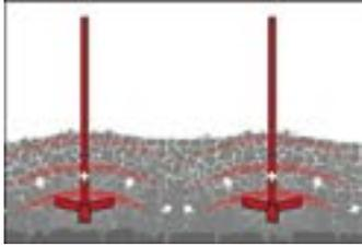
La dent LD a un étauçon droit et symétrique. Elle assure un soulèvement équilibré sur toute la largeur de la machine. Il n'y a aucun tassement latéral du sol.
