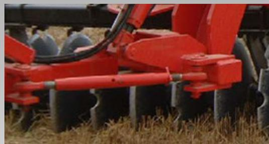
Pour affiner les réglages et garantir un grand confort de conduite, les modèles Class'VR Pro sont équipés d'un tirant réglable de dévers de flèche (cf photo ci-dessus). Celui-ci peut être remplacé en option par un vérin d'orientation hydraulique (cf photo ci-dessous), afin de pouvoir régler l'alignement de l'outil depuis la cabine du tracteur.
