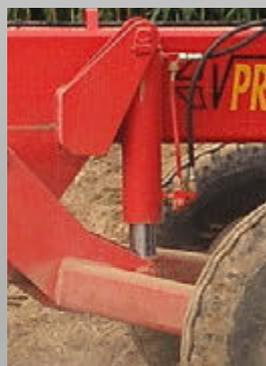
Sur l'ensemble de la gamme Class'VR Pro, le contrôle de profondeur s'effectue par l'essieu situé au centre de l'appareil.
