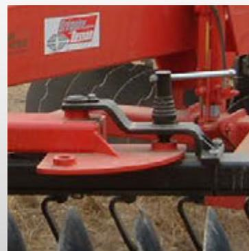
Le repliement et le verrouillage se réalisent manuellement de série ou hydrauliquement en option
