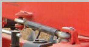
Le réglage d'ouverture des trains de disques avant s'effectue par l'intermédiaire d'un tirant réglable par vis. L'ouverture de l'angle arrière est hydraulique de série ce qui permet d'obtenir en fonction des réglages, un bon équilibre de l'appareil et une grande régularité de travail.
