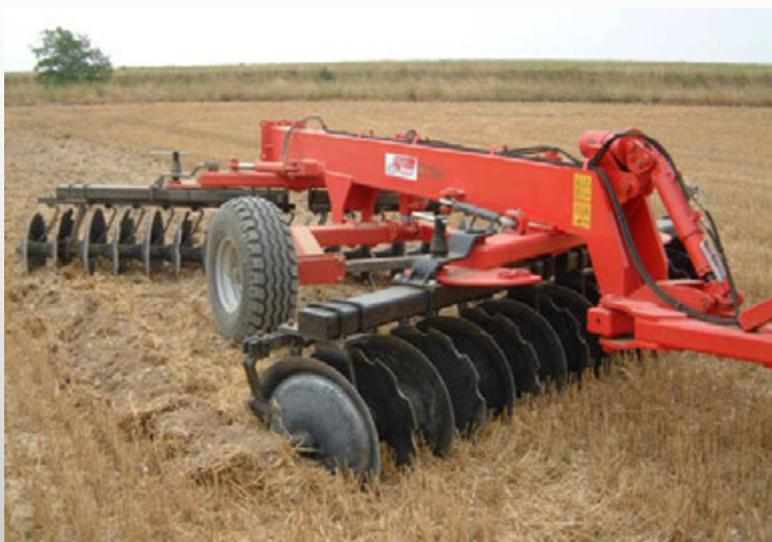
Cette nouvelle gamme de Pulvérisateur en V est équipée d'un nouveau châssis mono poutre 300 x 200 x 8 mm qui assure une grande robustesse de la machine et un grand confort d'utilisation :
