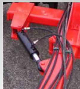
Pour affiner le réglage et garantir un grand confort de conduite, les modèles Class'VRL sont équipés de série d'un vérin de dévers de flèche.
