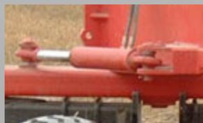
Le tirant mécanique du train de disque avant peut être remplacé en option par vérin hydraulique pour régler en continue l'ouverture des trains de disques depuis la cabine du tracteur.
