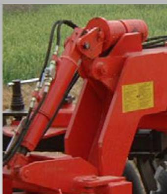
Les modèles de la gamme Class'VR Pro sont équipés de série d'un vérin de compensation hydraulique sur flèche complété par un amortisseur élastomère qui absorbe les chocs sans se déformer.
