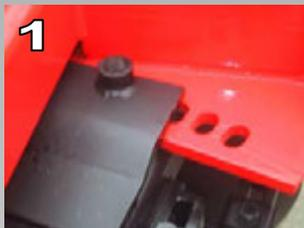
Le réglage d'ouverture et de fermeture des trains de disques se réalise à l'aide d'un secteur à trous et d'une broche (1) sur les modèles les plus simples (Modèles Class'VRL), ou à l'aide d'un tirant mécanique (2) ou Hydraulique (3)(Modèles Class'RPro) sur les versions plus élaborées. Ces deux systèmes très simples et sans entretien assurent un réglage minutieux des angles de train de disques.
