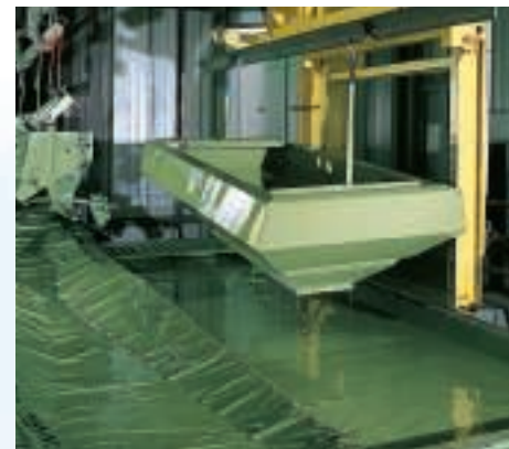
Etape importante du nouveau traitement anti-corrosion SULKY : le trempage par un robot dans un bain de peinture d'apprêt.
