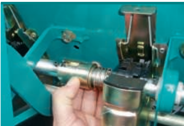
Le débrayage d'une demi-largeur de semis est possible (coté gauche).
