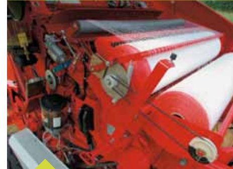
Le tube cintré d'étirement du filet étale le filet jusqu'aux bords de la balle.
