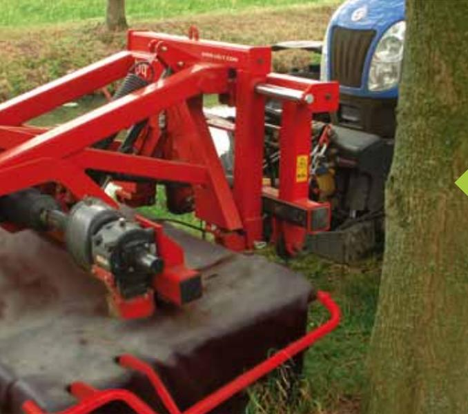
Pour une flexibilité accrue, un attelage coulissant peut être intercalé sur le relevage avant pour déplacer la faucheuse frontale hydrauliquement en déport latéral. Il est nécessaire, dans ce cas, de disposer d'un distributeur double effet supplémentaire. La translation de 30 cm permet de mieux faucher autour des obstacles et d'assurer un recouvrement supérieur avec la faucheuse attelée à l'arrière du tracteur.
