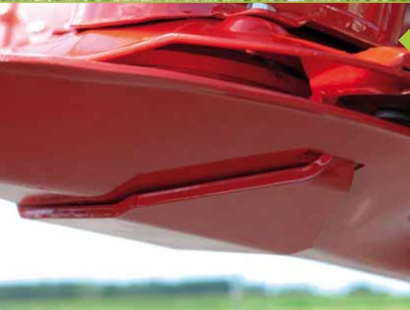
Les faucheuses HD sont équipées de patins d'usure de 8 mm d'épaisseur en acier traité.
