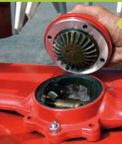
Chaque unité de fauche est étanche, remplie de graisse et en permanence lubrifiée. Même dans des conditions extrêmes, la graisse reste au niveau des pignons et ne s'accumule pas d'un côté du lamier, comme sur des lamiers conventionnels.
