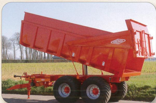
ORM 120 - côté standard, boggie, porte mécanique 2 vantaux, réhausse à grains 0,30
