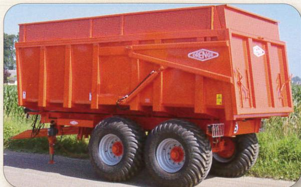
ORM 120 - côté 120, boggie, ceinture renforcée, porte hydraulique, 2 trappes
