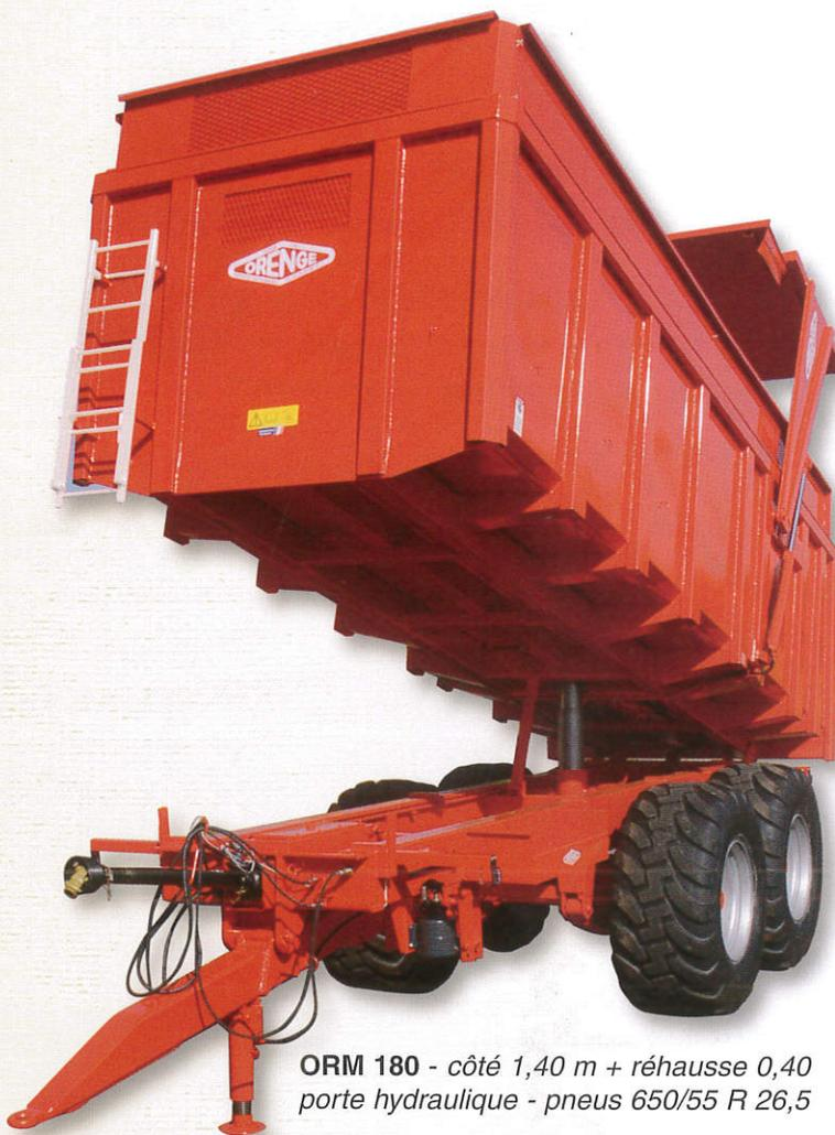
ORM 180 - côté 1,40 m + réhausse 0,40 porte hydraulique - pneus 650/55 R 26,5
