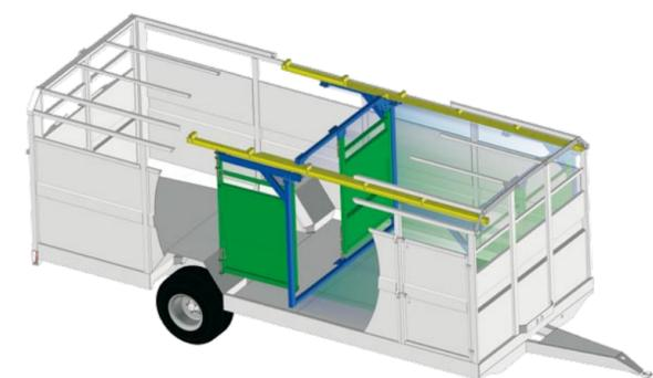
Cette séparation deux battants tôle est suspendue sur des rails. Son déplacement se réalise après déverrouillage tous les 16 cm. Des verrous permettent le blocage des deux battants en position ouvert et fermé. Ce modèle de séparation, portes en position ouverte s'arrêtent avant les passages de roues. Son positionnement contre la face avant de la bétailère, permet une utilisation totale du volume du véhicule.
