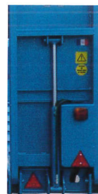
Remontée des rampes par vérins hydrauliques
