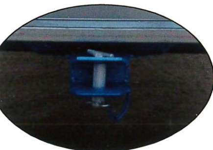
Attelage arrière de série jusqu'au R900PT
