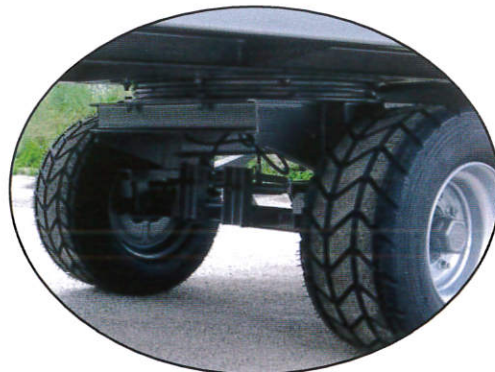
Direction en plaque tournante boulonnée
