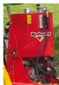
Centrale hydraulique PDF 540 tr/min, pompe 35L/min ou pompe double corps 35 L/min + 22 L/min (modèle ROTATIF)
