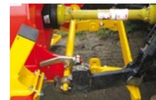
Attelage avec système de stabilisation évitant l'haubanage et permettant le report de charge au marteau.
