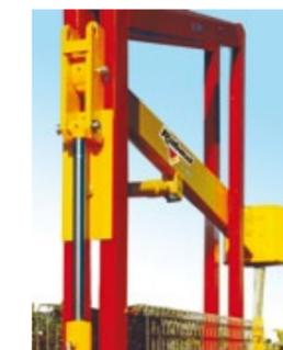
Réglage de la masse par vérin hydraulique
