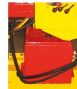
Centrale hydraulique PDF 540 tr/min, pompe 25 L/min
