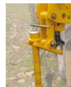
Pointerolle avec extraction hydraulique (sur VIBRESCOPIQUE II)
