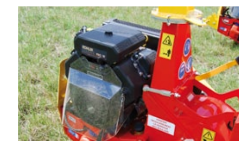
Moteur thermique KOHLER Essence 18 ch Réservoir 12 L
