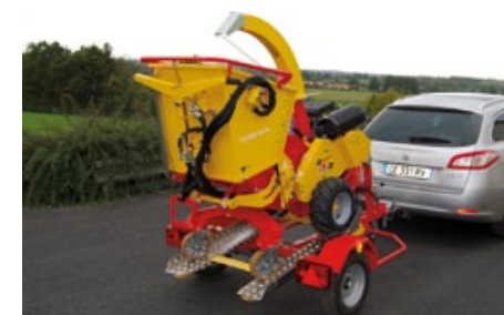
XYLOMIX 100 DA avec option remorque routière indépendante pour le transport
