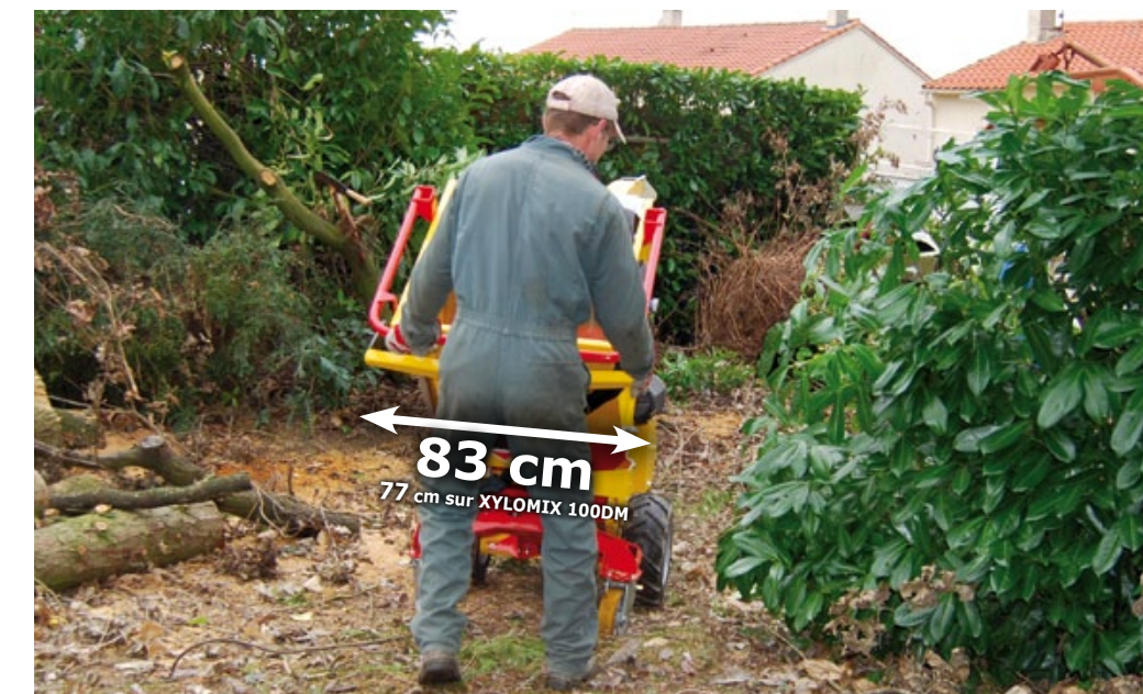
Un broyeur autotrtracté et compact pour un accès dans les zones les plus difficiles
