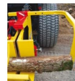
Butée réglable pour le contrôle de la longueur de coupe sur XYLOSCIE 700
