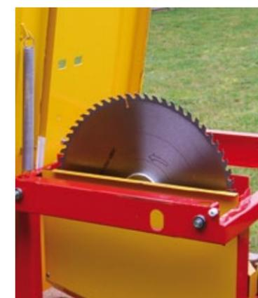
Lame au carbure Ø 600 mm
