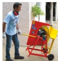
Transport par 2 roues à bandage + poignée sur XYLOSCIE 600
