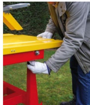
Verrouillage / déverrouillage de la table
