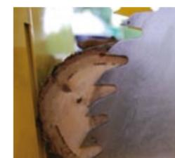
Lame en acier avec dents au **carbure**
