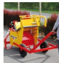
Option chariot de transport avec roues pneumatiques sur XYLOSCIE 700 (incompatible sur scie avec tapis)
