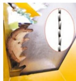
Lame en acier avec dents au carbure
