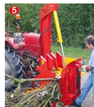
Coupe des branches en actionnant le couteau par la pédale
