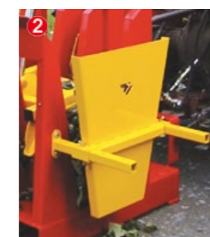
Réglage de la butée selon la longueur du fagot désirée (860, 960, 1060 ou 1160 mm).
