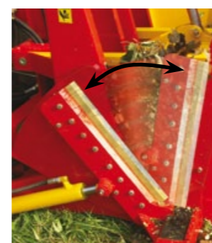
Couteau en acier haute résistance avec vérin double effet pour la coupe du fagot
