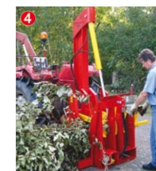
Compactage en actionnant la commande bimanuelle vers le bas.
