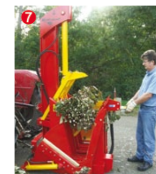
Relevage du fagot en actionnant la commande bimanuelle vers le haut.
