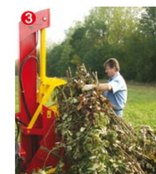
Mise en place des branches dans le "berceau".
