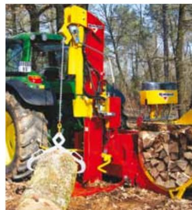
**F 20 FARMER II 1,15 m** avec centrale hydraulique + treuil et support fagoteuse
