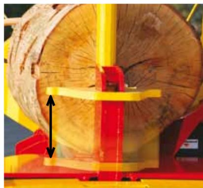
Coin étoile 4 tranchants réglable en hauteur par vérin hydraulique et flottant pour suivre le fil du bois.
