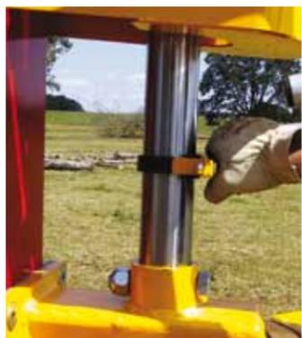
Dispositif de réglage programmable de la remontée du coin de 10 cm à 115 cm.
