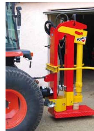
Vérin escamotable sur F14 MICROTRACTEUR. Idéale pour ranger dans un garage.
