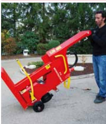
F12 MICROTRACTEUR en position transport avec les 2 roues
