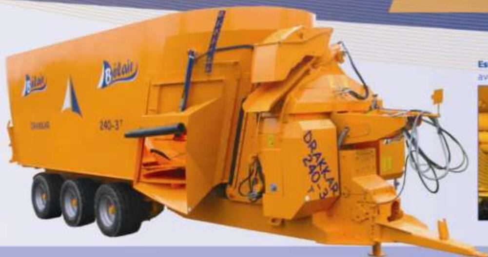
Essieu tridem avec essieu arrière suiveur (30 m³)
