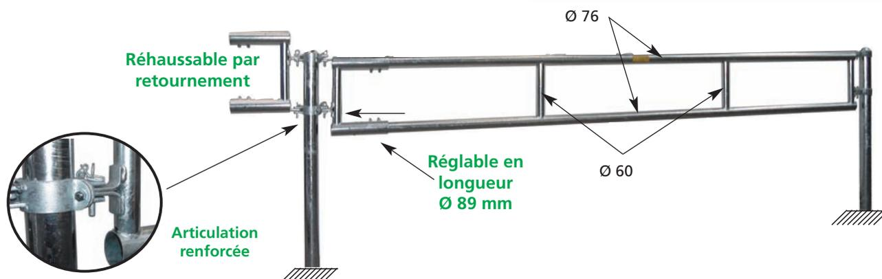
Constitués de 2 barres garrot de  $\text{Ø } 76 \text{ mm}$  assemblées par entretoises  $\text{Ø } 60 \text{ mm}$  sous forme de panneaux ouvrants, démontables et réhaussables de 150 mm par simple retournement. Peut être monter incliné ou droit.
