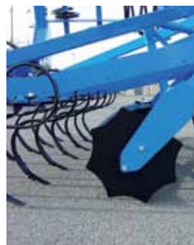
• Simple rouleau 8 barres □ 25 Ø320
