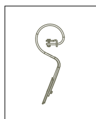
• Dent 32x12 droite. Dégagement 450 mm
