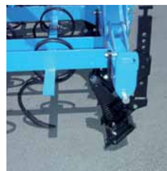
• Planche niveleuse avec dents □ 25 réversibles à l'avant
