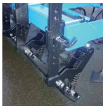
• Planche niveleuse sans dent à l'avant
