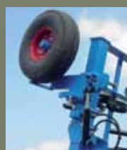
• Paire de roues pneus Ø535x168. 10 plis pour stabiliser les extensions en version repliable
