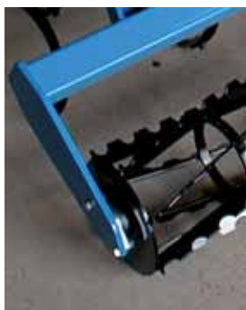
• Simple rouleau crénelé Ø270
