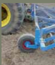
• Paire de roues pneus Ø535x168. 10 plis pour stabiliser les extensions en version repliable
