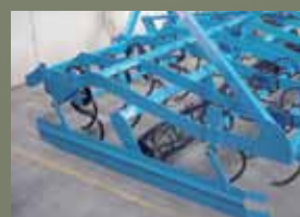
• Paire de déflecteurs laté- raux sur parallélogrammes à sécurité ressort
