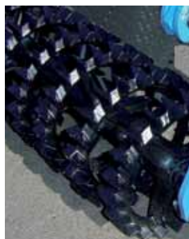
• Simple rouleau croskilette fonte Ø290
