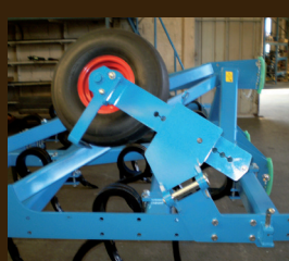
• Paire de roues pneus escamotables Ø535x168 sur CULTI 4000 fixe pour améliorer la stabilité
