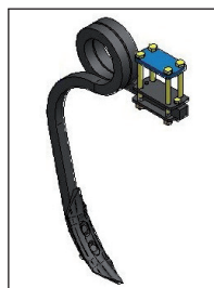
• Dent □35 double spire. Dégagement 720 mm
