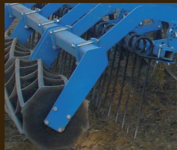
• Herse peignes escamotable, Ø16 sur 1 barre + rouleau 8 barres □ 25 mm, Ø445
