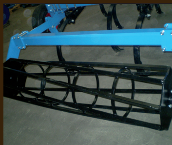
• Rouleau 8 barres □ 25 mm, Ø445
