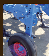
• Paire de roues pneus Ø535x168 sur outil CULTI 4000 repliable pour plus de stabilité
