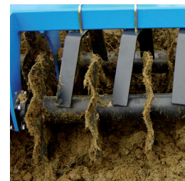
• Chasse mottes pour double rouleau disques ondulés Ø510
