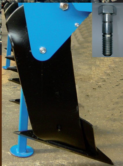
• Lame MICHEL avec sécurité boulon précisailé pour dégager la dent en cas d'effort trop important
