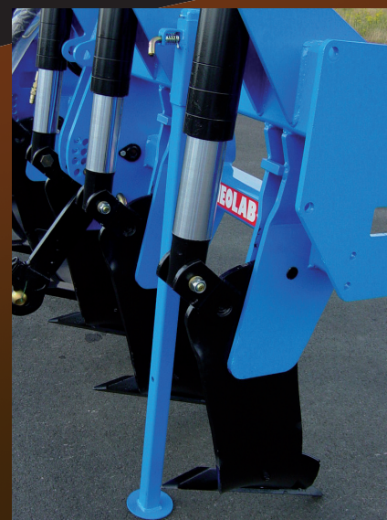
• Lame MICHEL NSH, équipée non-stop hydraulique, permettant à la lame de s'escamoter devant l'obstacle et de reprendre automatiquement sa position
