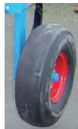
• Paire de roues de terrage pneus 10 plis Ø535x168
